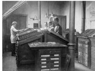
Schriftsetzerei mit Handsatzregalen in der Druckerei Johs. v. Helms, um 1907
