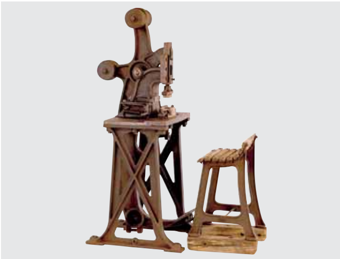
Pendel-Schlagpresse zur Herstellung von Seifenstücken, um 1900
